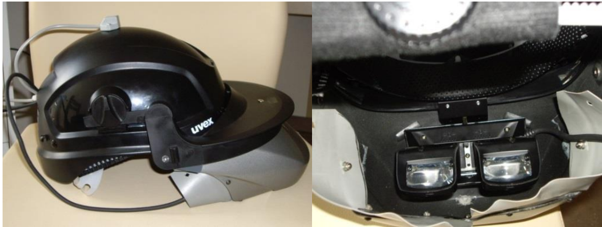
Abbildung 8: Neukonstruierter Helm mit Integration des Head Mounted Display
